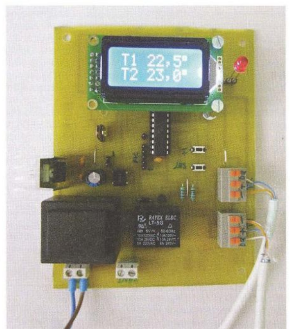
Obr. 4. Fotografie osazené desky
