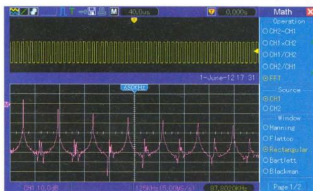
Obr. 26. Hantek 5202B - frekvenční analýza průběhu
