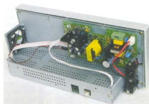
Obr. 24a. Doplnění ventilátoru do Hantek DSO5062B
