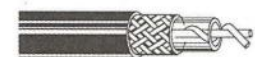
Obr. 13. Kabel s částečně vzduchovým dielektrikem. Má menší útlum, avšak horší mechanickou odolnost, při nedostatečně pečlivé montáži trpí navlháním. Mívá tvrzený vnější plášť
